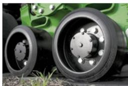
Halten das Raupenband auf der ganzen Fahrwerkslänge optimal in Kontakt mit dem Boden. Die hoch belastbaren Polyurethan-Laufrollen generieren weniger Hitze unter hohen Lasten und bieten eine längere Lebensdauer der mittleren Laufrollen.
